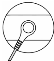
Obr. 1. Spôsob pripojenia kábla k elektróde
