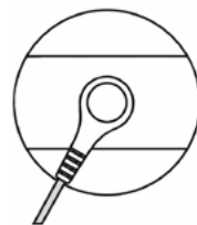
Fig. 1. Sätt att ansluta ledningen till elektroden.
