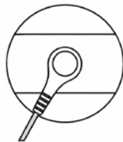
Obr. 1. Způsob připojení vodiče k elektrodě
