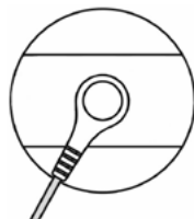
Fig. 1. Måte å koble ledningen til elektroden på.
