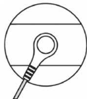
Рис. 1. Способ подключения провода к электроду
