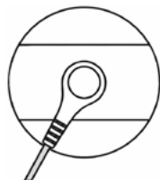
Obr. 1. Spôsob pripojenia kábla k elektróde
