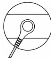
Abbildung 1. Art des Anschlusses des Kabels die Elektrode
