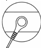
Fig. 1. Método de conexão do cabo ao eletrodo
